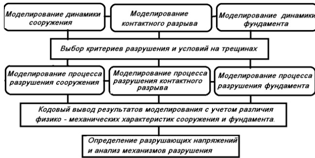
Рис. 2. Блок-схема моделирования динамического разрушения строения.
