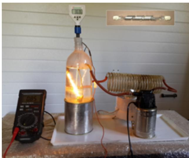
**Рис. 9.** Галогенная лампа накаливания, обернутая лентой из сплава олово-свинец в сосуде с водой. Вода прокачивается через змеевик, охлаждаемый вентилятором.
