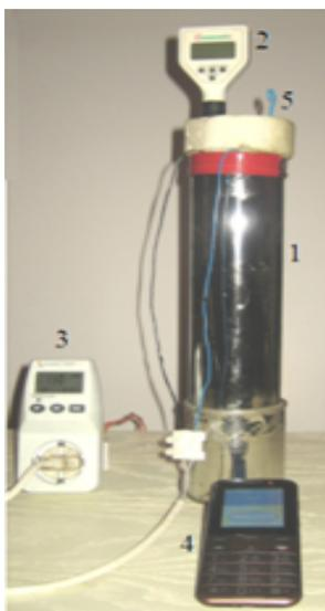
**Рис. 6.** Экспериментальная установка с водным калориметром. 1 – сосуд Дьюара с водой, в которую погружена лампа накаливания, 2 – термометр, 3 – измеритель величины тока, напряжения и потребляемой мощности, 4 – секундомер, 5 – размешиватель.
