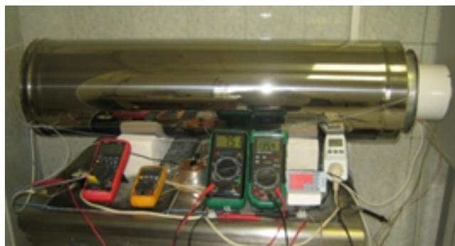
Рис. 4. Воздушный проточный калориметр.
