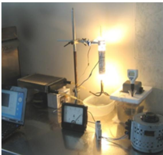
Рис. 8. Экспериментальная установка с циркулирующим раствором  $KNO_3$  и галогенной лампой накаливания.
