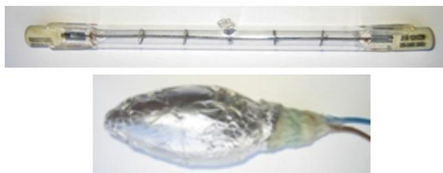
**Рис. 2.** Галогенная лампа накаливания и лампа накаливания мощностью 40 Вт, обернутая алюминиевой фольгой.
