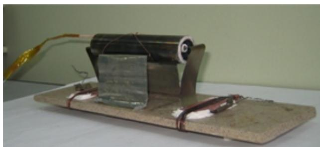
Рис. 3. Галогенная лампа накаливания внутри цилиндрического контейнера.
