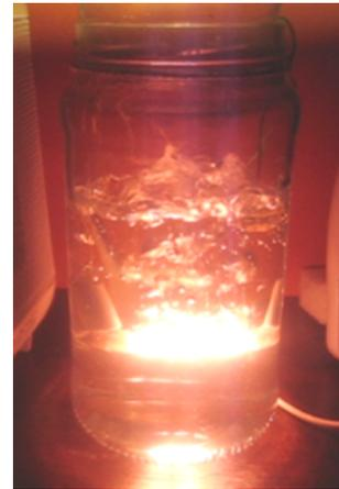
Рис. 10. Галогенная лампа накаливания в кипящей воде с суспензией  $\text{NaBiO}_3$ .
