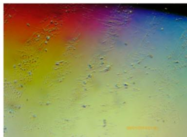
Рис. 10. Следы на CD после 3х часовой экспозиции рядом с газовой горелкой.
