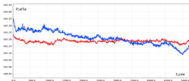
**Рис. 19.** Изменение давления в замкнутых сосудах (объем = 0.5 литра), облучаемых «темным водородом»: синяя кривая - 5 см от разряда, красная кривая – 30 см от разряда
