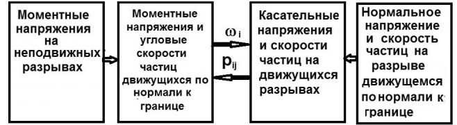
Рис. 2. Схема построения вычислительных схем в граничной точке среды при той же последовательности вычисления скоростей.
