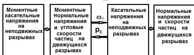
Рис. 1. Схема взаимодействия продольных волн кручения с поперечными волнами обычных напряжений и скоростей частиц.
