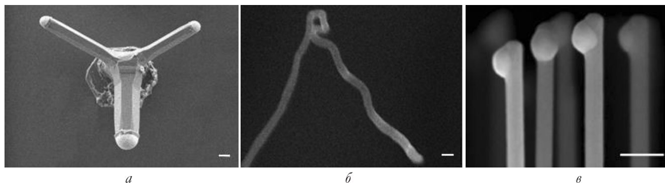
Рис. 3. Неуправляемый ПЖК-рост: (а) ННК Si_xGe_{1-x} с разрывом капли и ветвлением кристалла, (б) ННК Si с изгибами, (в) ННК InAs с миграцией капель на боковые стенки [11]. Масштабные полосы 100 нм.
