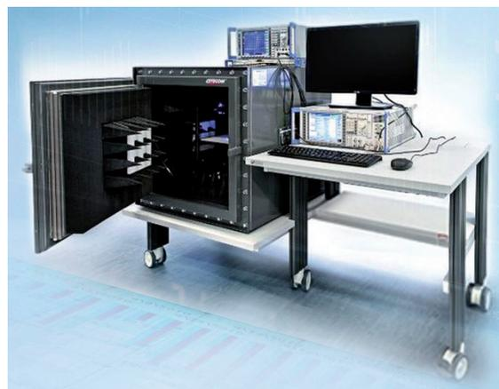
Рис. 1. Беспроводная испытательная система WTS-80.
