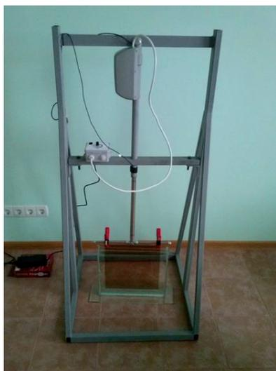
Рис. 1. Устройство для нанесения покрытий методом *dip-coating*.
