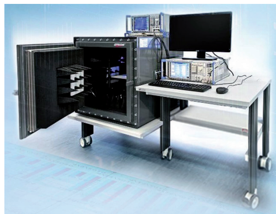
Рис. 1. Беспроводная испытательная система WTS-80.
