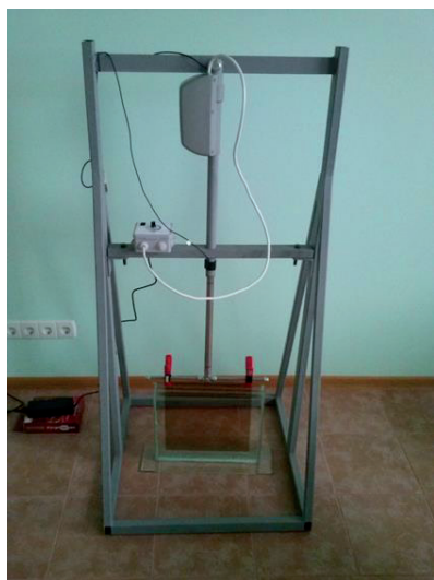
Рис. 1. Устройство для нанесения покрытий методом dip-coating .
