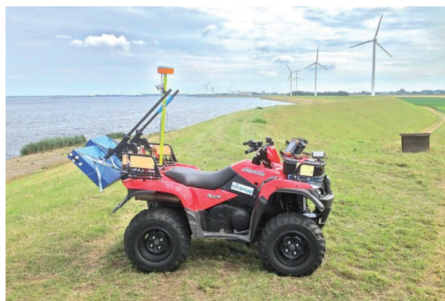
Рис. 3. Система из двух радиометров на квадроцикле.
