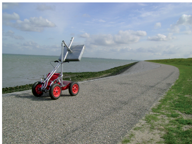
Рис. 4. Перемещение радиометра на тележке.
