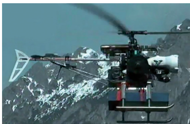
Рис. 1. Размещение радиометра на БПЛА.
