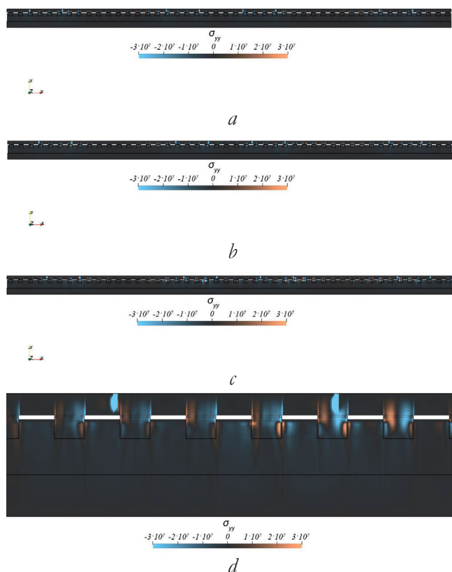
Рис. 6. Движение подвижного состава из двух элементов по мосту: a – начало движения, b – 0.0255 с, c – 0.051 с, d – укрупненная картина слева в момент 0.051 с.
