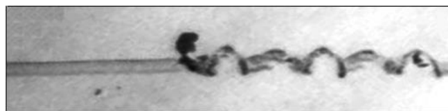
Рис. 4. Переход периодического трека (период 45 мкм) в гладкий (или наоборот). Поликарбонат. Оптический микроскоп [15].
