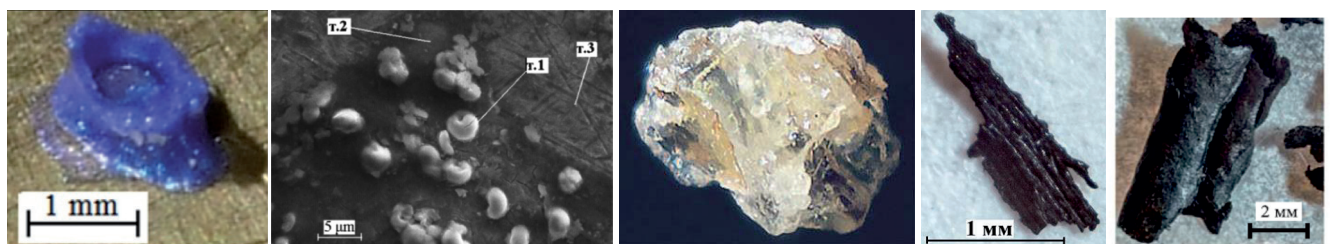
Рис. 7. РЭМ-изображения частиц, синтезированных в экспериментах с разными газами при высоком давлении.
