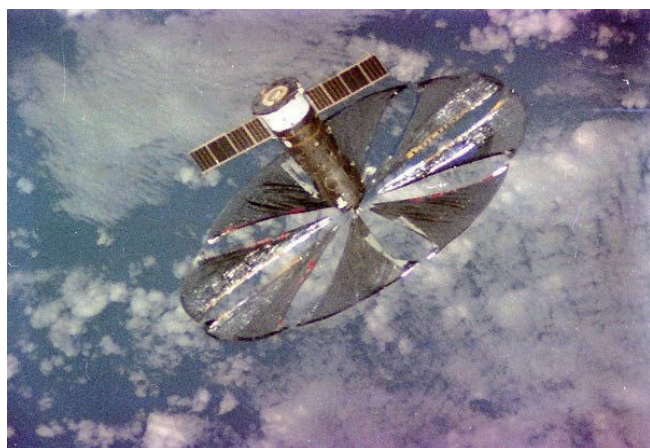
Рис. 3. Космический аппарат "Прогресс М-15" с развернутым солнечным парусом, 1993 г.
